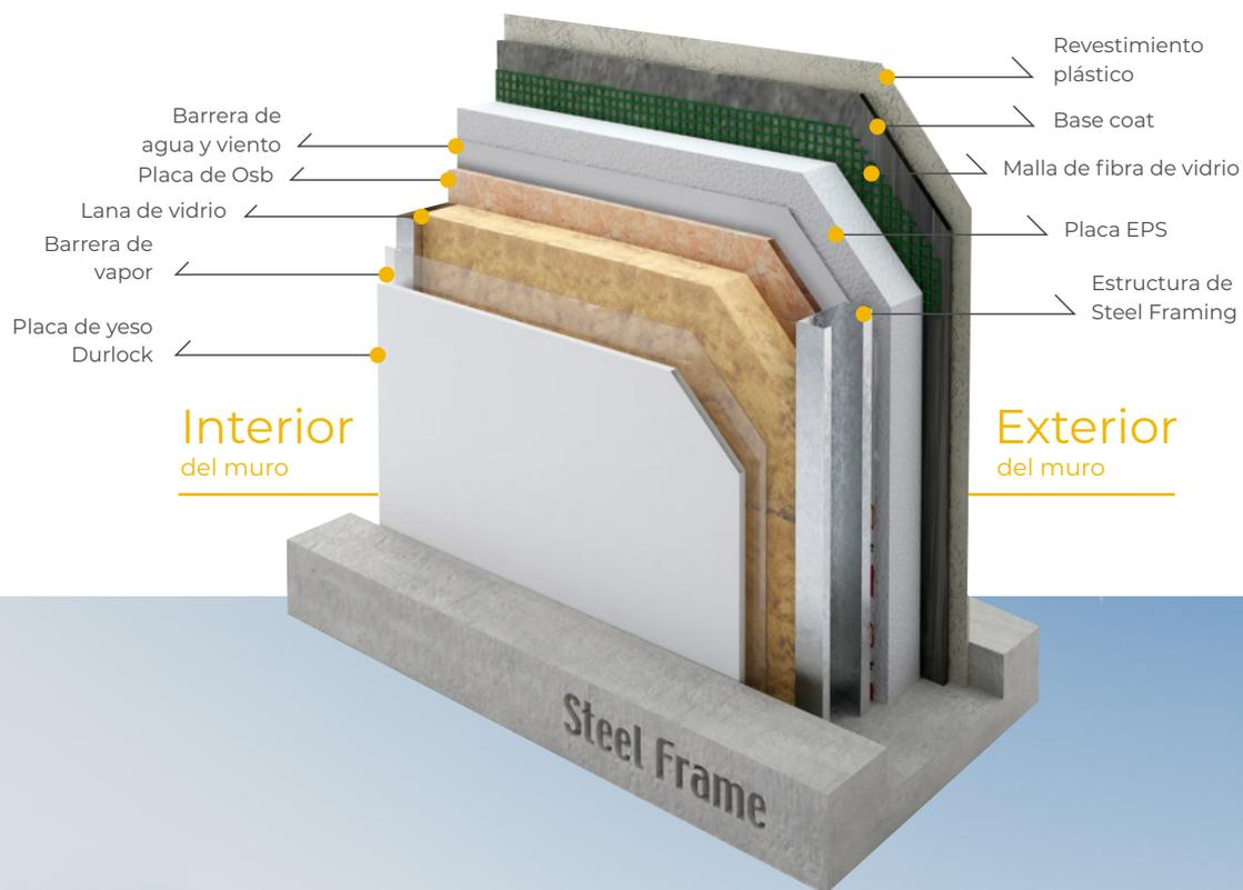
Un sistema de aislaciones multicapa que mejoran el rendimiento térmico y acústico de la obra.
